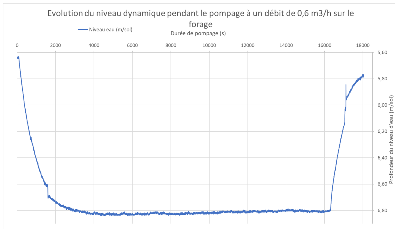
Figure 26 : Hydrogramme du forage obtenu lors du pompage du 22 février 2022 au débit de 0,6 m 3 /h - suivi automatique
